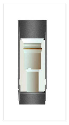
Стоп-патрубок предназначен для получения сигнала об окончании продавливания разделительной пробки при сплошном цементировании хвостовика за счет её герметичной посадки в приемное седло внутри стоп-патрубка.
