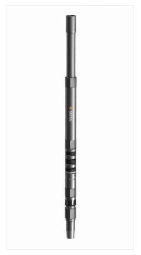
Подвески хвостовика нецементируемые предназначены для проведения спуска потайной обсадной колонны (хвостовика) без проведения цементирования с последующей подвеской спускаемого хвостовика в предыдущей обсадной колонне, разъединением хвостовика от транспортировочной колонны и герметизацией межколонного пространства, также подвески применяются при спуске хвостовика с проведением промывок через башмак. Подвески, после срабатывания, разбуривания не требуют.
