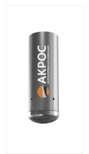
Башмак колонный металлический с обратным клапаном предназначен для направления обсадной колонны по стволу скважины при спуске и предотвращения обратного перетока тампонажного или бурового раствора из заколонного пространства во внутреннее пространство обсадной колонны.
