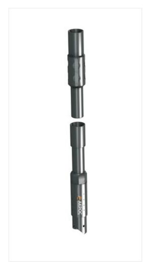
Надставка стыковочная для подвески хвостовика предназначена для проведения герметичной стыковки колонны НКТ с подвеской хвостовика для защиты эксплуатационной колонны от воздействия высокого давления при проведении гидроразрыва пласта.
